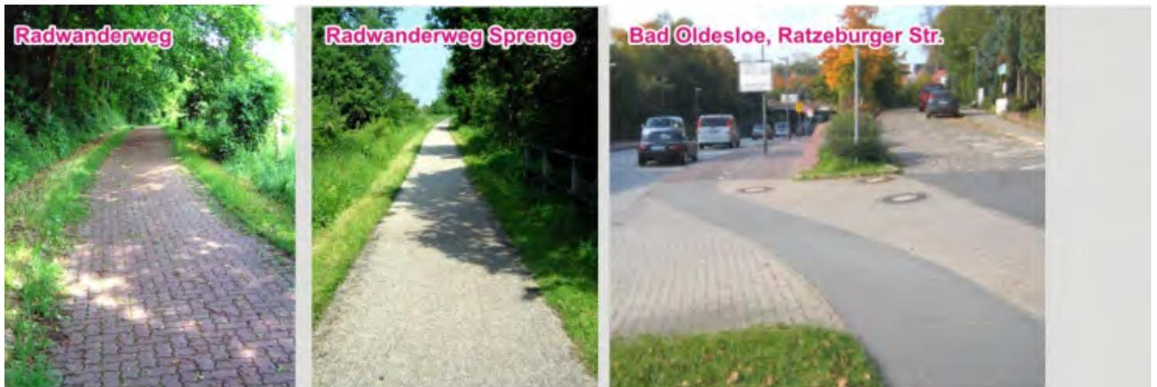
Bei der Belagsauswahl spielen neben der gestalterischen Integration und den Baukosten vor allem die Nutzungsfreundlichkeit eine zentrale Rolle. Asphaltbeläge bieten z.B. bei starken Neigungen nicht immer die beste Lösung. Häufig bieten Pflaster- oder Asphaltmischdecken eine gute Lösung.
