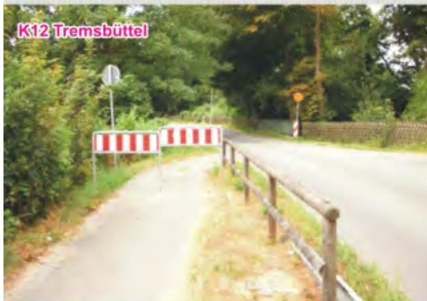
Beabsichtigte Verringerung des Konfliktpotenzials an einer unübersichtlichen Querung baut zusätzliche Barriere für den Radverkehr auf und reduziert den Querungskomfort.
